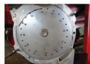
Ekim düzgünliğini izleme imkanı veren pencereler, ekim diskine destek diskii, hassas tohum tekleme sistemi.
