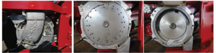
Ekim düzgünlüğünü izleme imkanı veren pencereler, ekim diskine destek diski, hassas tohum tekleme sistemi. Seeding inspection windows, seeding disc support, precise mono seed mechanism.
